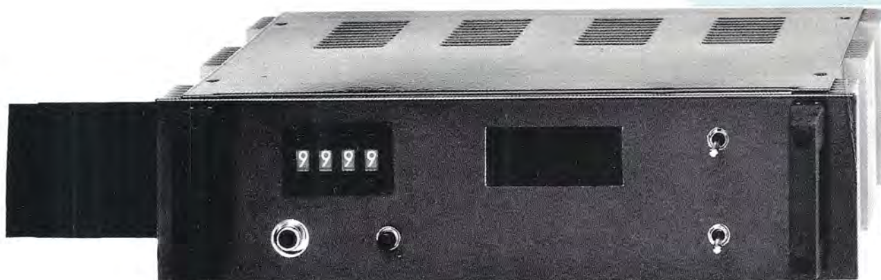
Fig.1 Ecco come si presenterà questo contapezzi una volta racchiuso entro il suo mobiletto. Il pannello visibile in questa foto verrà fornito già forato e con scritte serigrafate, che qui ancora non compaiono, perchè è il prototipo.
