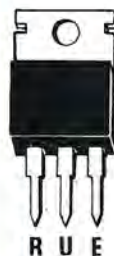
Fig.3 Disposizione dei terminali dell'integrato LM.317. Ricordatevi che l'aletta metallica che esce dal corpo, si trova a diretto contatto con il terminale U.
